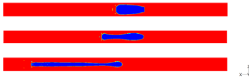
شکل (۱۰): نمای تغییر شکل حباب هوای شماره ۱ در زمان در شیب ۰/۵٪ از بالا (بخش متقارن اضافه شده است)
