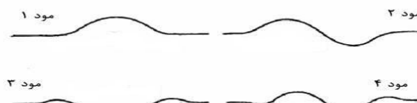
شکل ۱ - مدهای کمانش جانبی
